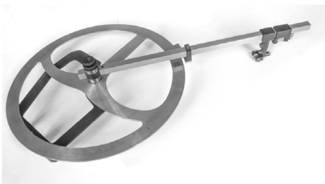
Apparat zur Integration der Riccati-Differenzialgleichung aus der Göttinger Sammlung mathematischer Modelle und Instrumente (Modell 564, Foto: Sven Wiese)
