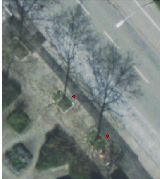
Abbildung 15: Lagefehler durch ungenaues DGM: Tatsächliche Stammfußpunkte (rot) der Bäume im Vergleich zur Lage in einem Orthophoto, das mit einem ungenauen Geländemodell berechnet wurde
