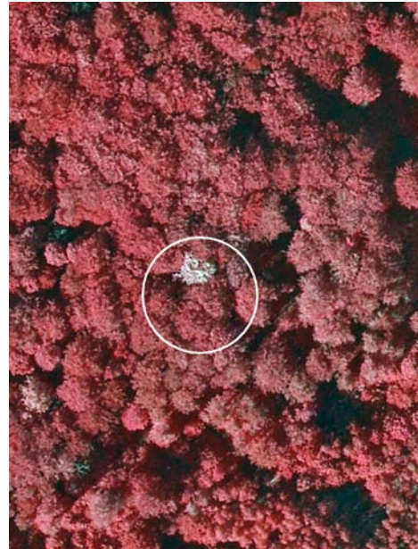
Orthophoto auf Basis DGM Lagefalsche Kronendarstellung, Probekreis liegt auf Geländehöhe
